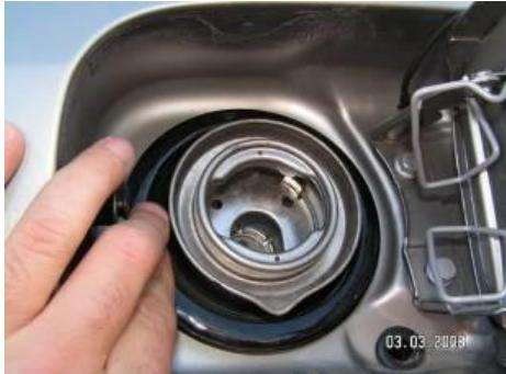
U izuzetnim situacijama može nastati potreba da se gorivo istoči u kanistar ili bure. Sistem je programiran tako da ne dozvoljava ovakva istakanja kako bi osujetio neautorizovano točenje goriva. Problem se rešava upotrebom specijalnih identifikacionih kartica koje su "opremljene" pravom na točenje i kada transponder (identifikator vozila) nije u polju antene za identifikaciju vozila. Po okončanom točenju, svi parametri ostaju upisani u memoriju kontrolera i dostupni su za naknadne provere.
