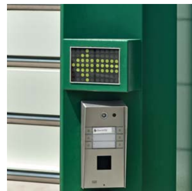
LANE LIGHT - display za pokazivanje smeru kretanja i audio IP interfon
