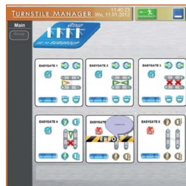
MON SOFTWARE - Software za udaljenu kontrolu tripoda
